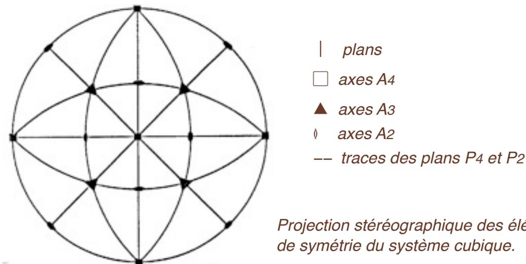
La forme dont les faces sont normales aux axes  $A_4$  est le cube, ou hexaèdre. Les faces sont aussi perpendiculaires aux axes de coordonnées. Leur notation générale est  $\{001\}^1$ .
