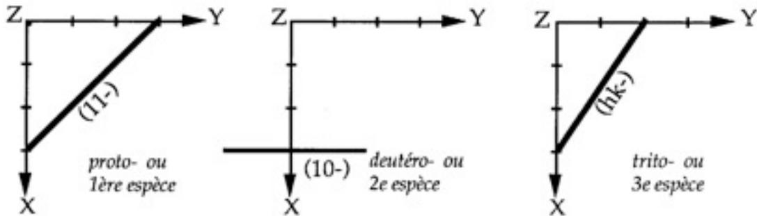
Orientation des prismes, pyramides et bipyramides vis-à-vis des axes de coordonnée
