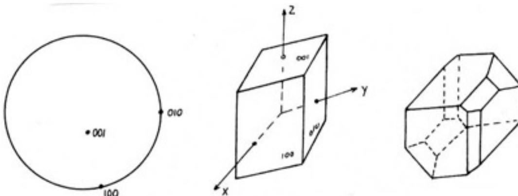
Parallélépipède défini par les pinacoïdes  $\{100\}$ ,  $\{010\}$  et  $\{001\}$ . Les arêtes définissent les axes X, Y et Z.
