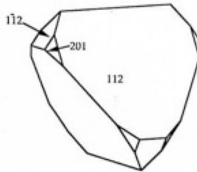
**Chalcopryrite** : deux sphénoèdres conjugués inégalement développés, {112} et  $\{\bar{1}\bar{1}2\}$ , et deutrobipyramide {201} peu développée.
