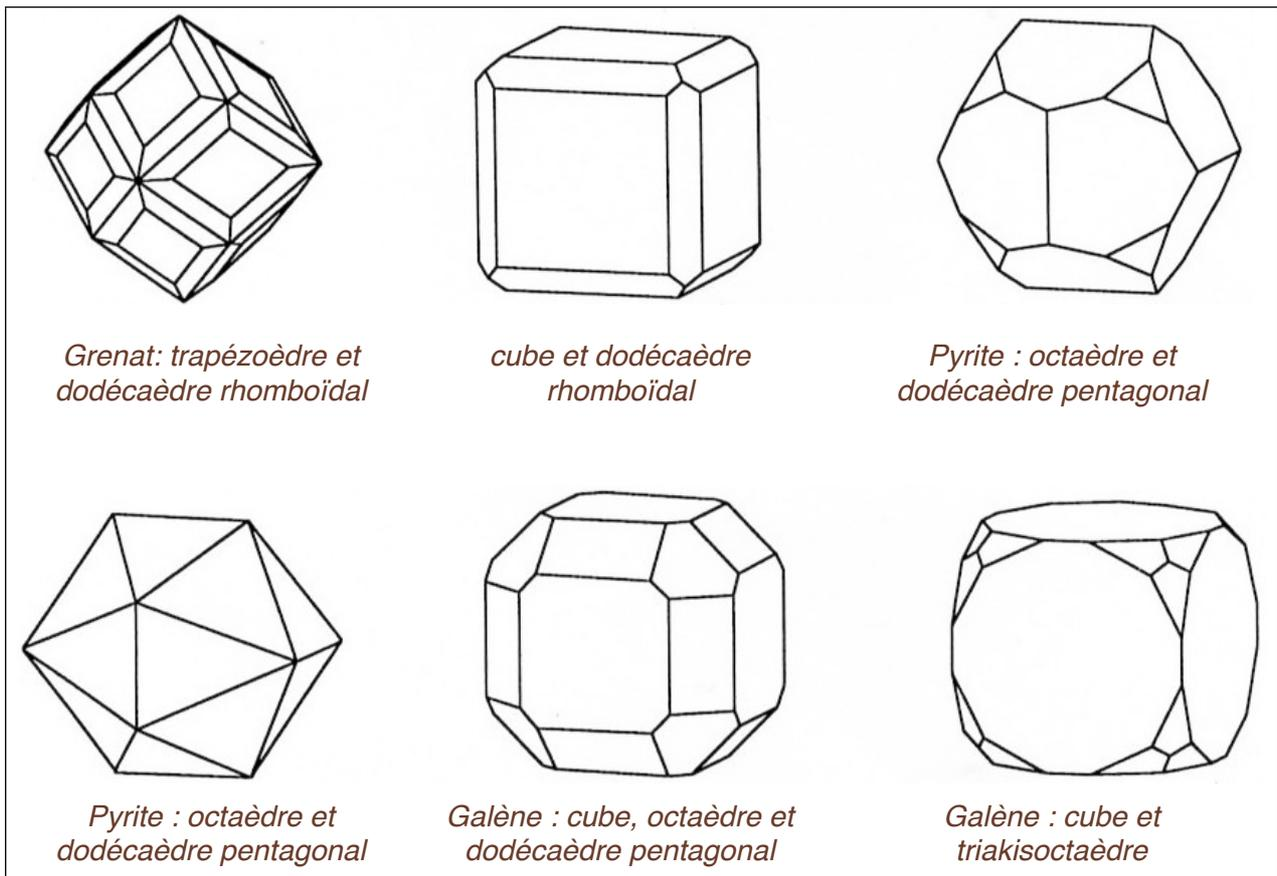
Les grenats montrent très souvent la combinaison du trapézoèdre et du dodécaèdre rhomboïdal. La pyrite présente les combinaisons du cube, de l'octaèdre et du dodécaèdre pentagonal. Parfois même, suivant le développement relatif des faces, la combinaison de l'octaèdre et du dodécaèdre pentagonal font croire à un solide à 20 faces, constitué en
