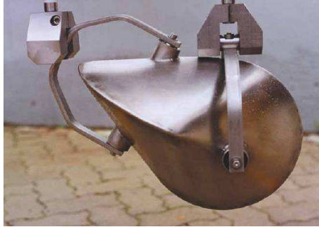
Abbildung 3.3: Das Oloid als Rührkörper
