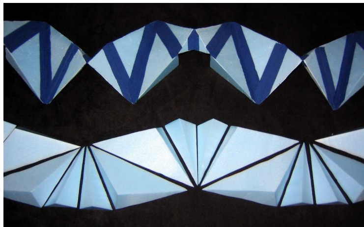
Abbildung 2.74: Anordnung der Glieder beim V Kubus I und V Kubus II. Man beachte, dass die Gelenke im Gegensatz zur ersten Version bei der zweiten alle in einer Ebene liegen
